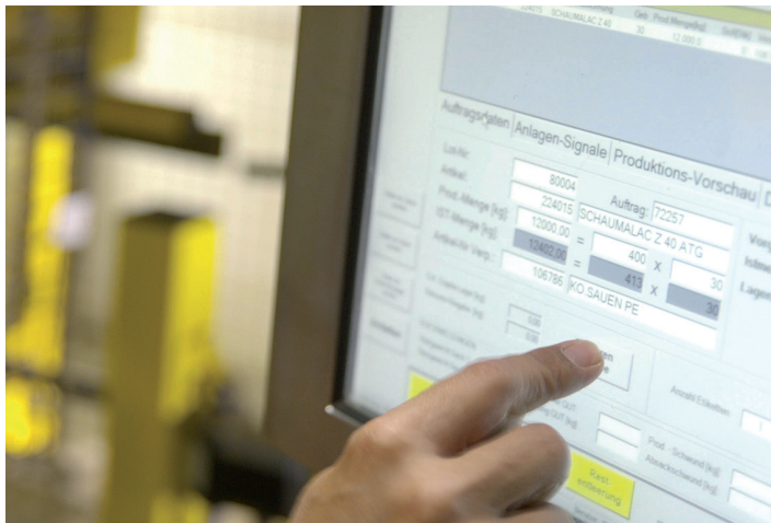
Abb. 4: Die im Prozessleitsystem hinterlegten Daten werden beim Start an die Absackanlage gesendet.
